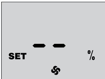
После входа в режим настройки на дисплее панели управления отображается индикатор **SET %**.
