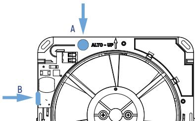
Зробіть отвір [A], передбачений для проходження кабелів; у разі зовнішніх підключень без клемної колодки зробіть отвір з боку [B] як на блоці вентилятора, так і на кришці.
