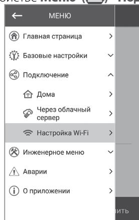
Затем нажмите **Получить.** На экране будут отображены текущие настройки параметров Wi-Fi. Выберите один из режимов работы Wi-Fi: **Access Point** или **Client.**
