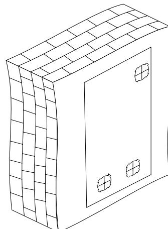
Снимите шаблон и просверлите в стене два сквозных отверстия Ø 120 мм для круглых воздуховодов.
