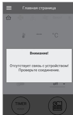
По умолчанию установка работает как точка доступа Wi-Fi. После установки приложения подключите мобильное устройство к установке как к точке доступа Wi-Fi с именем (**FAN: + 16 символов ID-номера**), указанным на плате управления и на корпусе установки.
