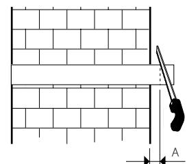
Вставьте воздуховоды в соответствующие отверстия шаблона. Обеспечьте минимальный уклон воздуховода 3 мм в сторону улицы для отвода конденсата.
