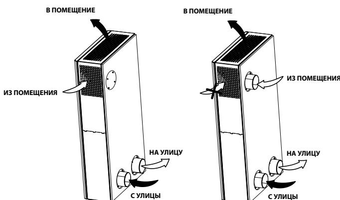
В установке предусмотрен монтаж вытяжного патрубка ( $\varnothing 100$  мм) для обслуживания другого помещения, например, ванной комнаты. Патрубок входит в комплект поставки. Вытяжная решетка должна быть закрыта магнитной заглушкой, входящей в комплект поставки (см. раздел "Монтаж и подготовка к работе").
