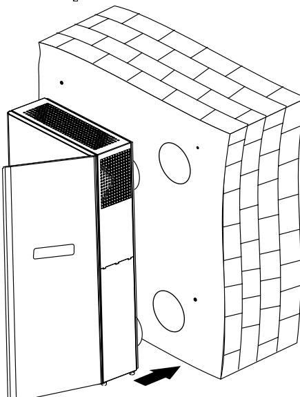
Поднимите установку, вставьте патрубки в соответствующие установленные в стене воздуховоды. Наклон воздуховодов должен быть минимум 3 мм.
