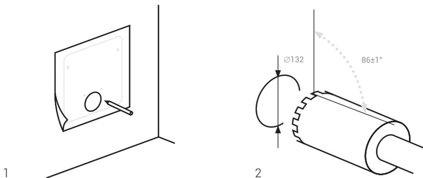
Рисунок 6.2 – Бурение воздушного канала
