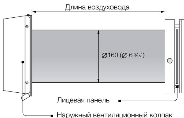
Длина воздуховода зависит от модели проветривателя (см. „Структура условного обозначения“ стр. 4).
